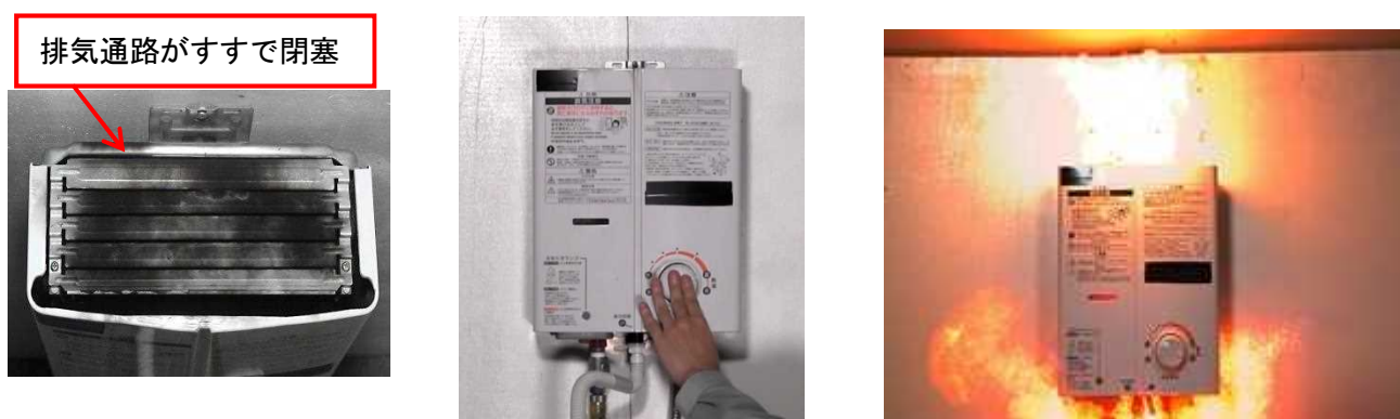
写真3 屋内式ガス瞬間湯沸器が異常着火している様子
